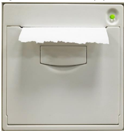
Figura 2-6 Instalación de papel térmico (3)
