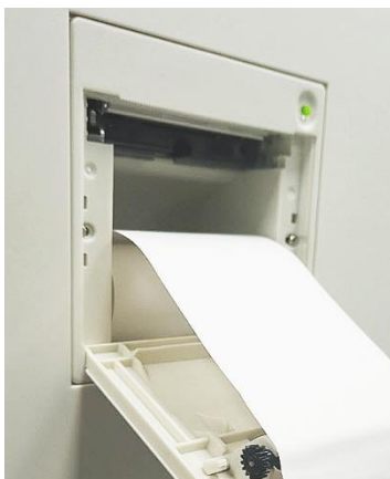
Figura 2-5 Instalación del papel térmico (2)
